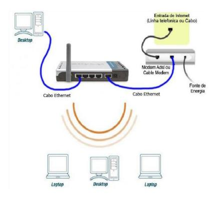
\*Para que o Roteador DI-524/150 navegue na internet utilizando a configuração em modo Dynamic IP Address, o Modem ADSL deve estar configurado em modo Router. Para saber se o seu modem utiliza essa configuração basta notar se com ele direto ao PC **Não** necessite de um discador de banda larga com nome de usuário e senha do provedor de acesso.
