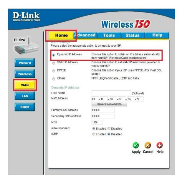
4- Na tela de configuração **Dynamic IP Address**, se a sua conexão necessita de **MAC Address** cadastrado, digite-o nos campos **MAC Address** ou caso não necessite apenas clique no botão **Clone MAC Address**.
